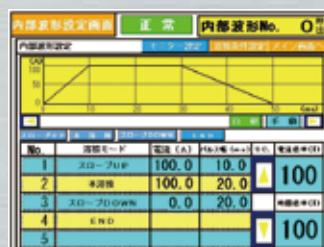
内部波形設定画面／Internal Waveform Setting Screen
