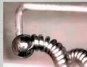
電球フィラメント／Bulb Filament
